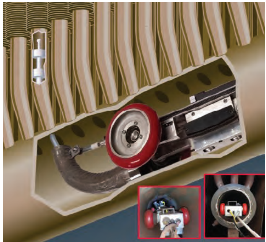
1. HRSG internal access tool in an HP evaporator header
